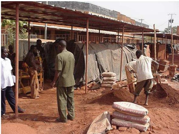
**Photo 3** : Production de BTC par des petites entreprises locales utilisant des presses manuelles.
